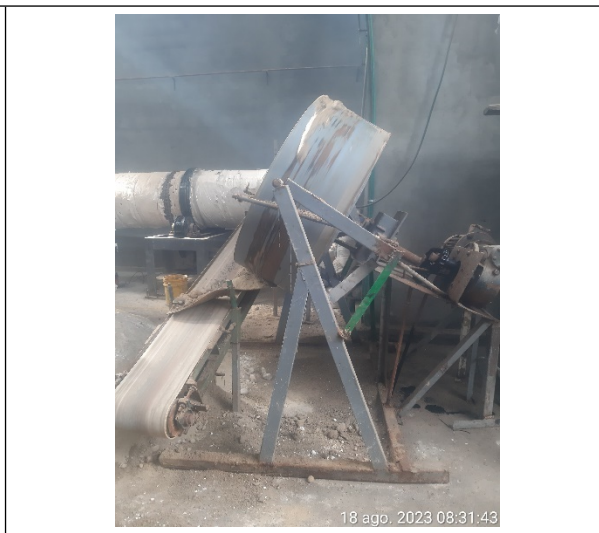
Fotografía No. 4 Olla granuladora y banda transportadora
