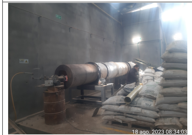
Fotografía No. 5 horno de secado cilíndrico rotativo
